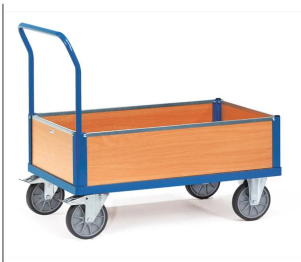
Ensemble mécano-soudé, revêtement époxy bleu RAL 5007, plateau et ridelles en bois, hauteur 250 mm. 2 roues pivotantes et 2 roues fixes à bandage TPE, moyeu à roulement à billes central. Freins sur roues pivotantes conformément à la Norme 1757-3 (Sécurité des chariots de manutention).
