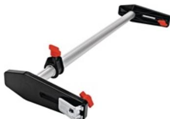
tube rond télescopique en aluminium avec vis de verrouillage pour un travail précis, fixe et soutient doucement le cadre de la porte lors du moussage du joint mural, les pièces de serrage sur les surfaces de serrage fixent l'entretoise dans le cadre de la porte
