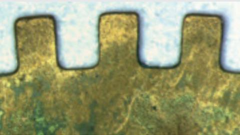
Oxydation d'une roue dentée
