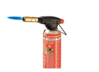
avec allumage piézo · appareil de soudage et de préchauffage performant · pour travaux de réparation et de maintenance · avec valve à régulation fine pour le réglage précis de la flamme du brûleur convient pour le brasage fort de tubes en cuivre jusqu'à 15 mm de Ø et le brasage tendre jusqu'à 28 mm de Ø
