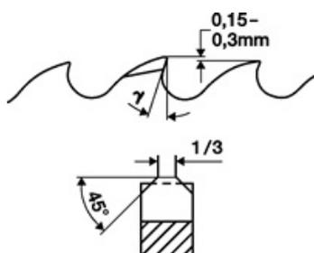
**Forme de la dent BW** : Denture crochet avec pan incliné en alternance
