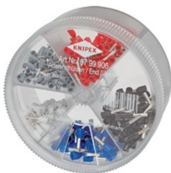
**Contenu de la livraison : 50 x embouts de câble KNIPEX blancs 14 mm (50 x 0,5 mm<sup>2</sup> / AWG 20), 100 x embouts de câble KNIPEX gris 14 mm (100 x 0,75 mm<sup>2</sup> / AWG 18), 100 x embouts de câble KNIPEX rouges 14 mm (100 x 1 mm<sup>2</sup> / AWG 17), 100 x embouts de câble KNIPEX noirs 14 mm (100 x 1,5 mm<sup>2</sup> / AWG 15), 50 x embouts de câble KNIPEX bleus 14 mm (50 x 2,5 mm<sup>2</sup> / AWG 13)**
