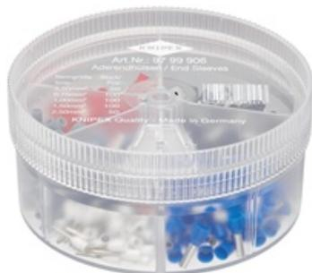
97 99 906 Boîtes d'assortiments Boîte à saupoudrer pratique, empilable et refermable · Boîte à saupoudrer pratique et transparente · Couvercle rotatif avec ouverture pour le prélèvement des embouts de câble individuels · Avec embouts de câble isolés selon le code couleur DIN · Format : Ø 90 mm , hauteur 44 mm
