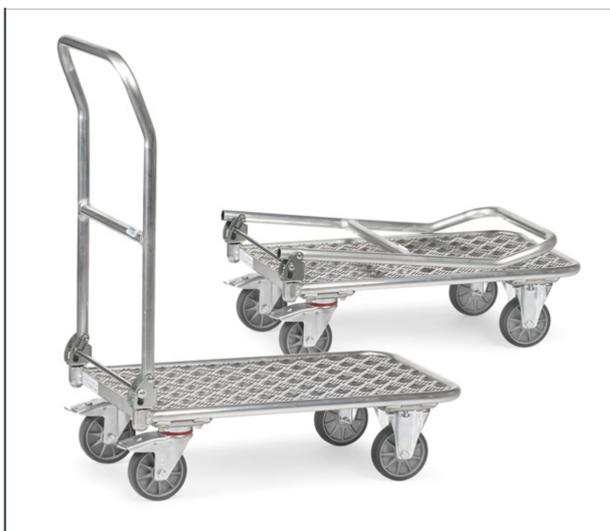
Chariot en tube d'acier et plateforme alu. Dossier rabattable sur la plateforme. 2 roues pivotantes et 2 roues fixes à bandage TPE, moyeu à roulement à billes central. Freins sur roues pivotantes.
