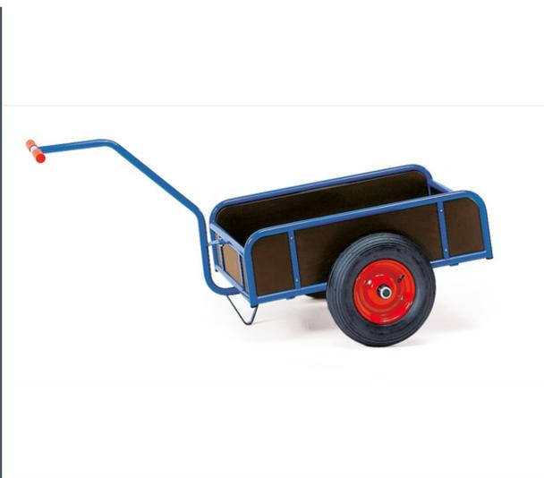
Char à bras léger en tube d'acier soudé, revêtement époxy bleu RAL 5007. Timon à boulonner, Plateau en contreplaqué hydrofuge. Avec 4 ridelles en contreplaqué hydrofuge hauteur 250 mm. Roues gonflables, moyeu à roulement à rouleaux.
