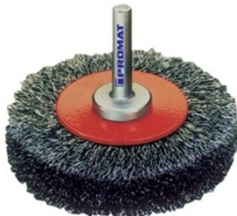
**fil d'acier ondulé** · le petit diamètre de cette brosse permet une utilisation dans les endroits difficilement accessibles, surfaces intérieures et rainures · pour nettoyer et enlever la rouille · pour une utilisation sur les perceuses / meuleuses droites · **Ø de la tige 6 mm** ·
