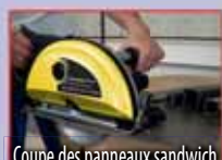
Coupe des panneaux sandwich tôles et profilés jusqu'à 10 mm avec Cuts metal sheets & profiles up to 10 mm,
